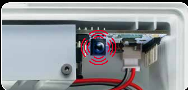
LED RVB pour l'affichage du test automatique et de l'état de la batterie
